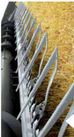
FreeFlow-Schneidwerk mit Einzugsringen und verstellbaren Ährenhebern.
