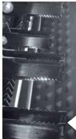
Häcksler mit gezahnten Messern und spezieller Feinschnittvorrichtung.
